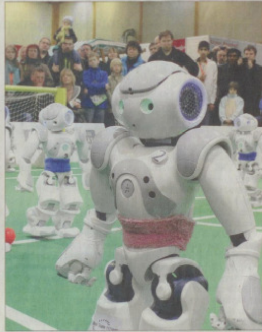
Ein Spiel der Standard-Plattform-Liga. Die hier eingesetzten Roboter vom Typ „Nao“ verfügen über 21 angetriebene Gelenke.
